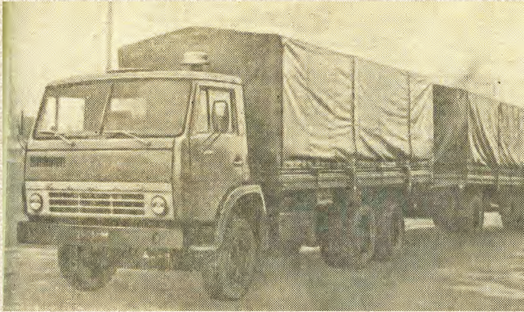
Грузовой автомобиль КамАЗ- 53302 с удлиненной бортовой платформой и с прицепом ГKB-8350
