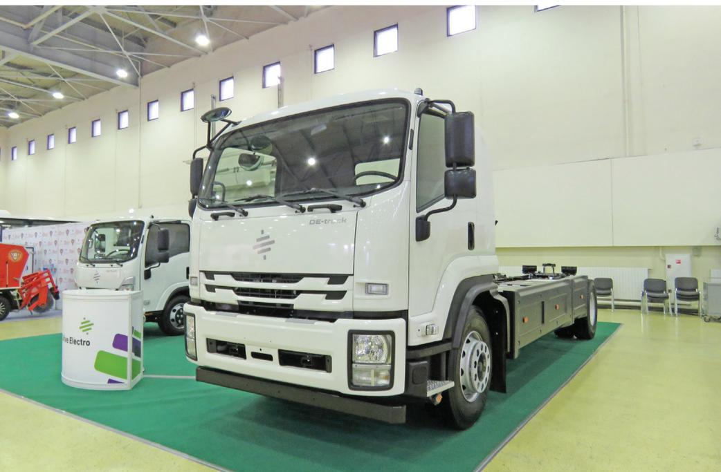
**Компания Drive Electro представила два электро-мобильных шасси, предназначенных для формирования транспортных средств полной массой 9,5 и 18 тонн**
