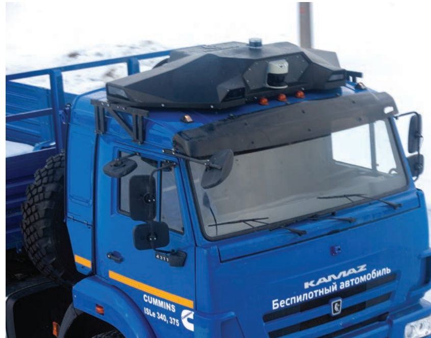
Новая разработка «КАМАЗа» – накрышный модуль автономного управления автомобилем
