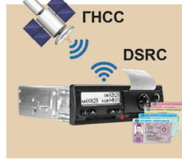
Smart-тахограф (ЕСТР тахограф) = цифровой тахограф + определение местоположения ТС + использование ближней радиосвязи «DSRC» для определения наличия нарушений
