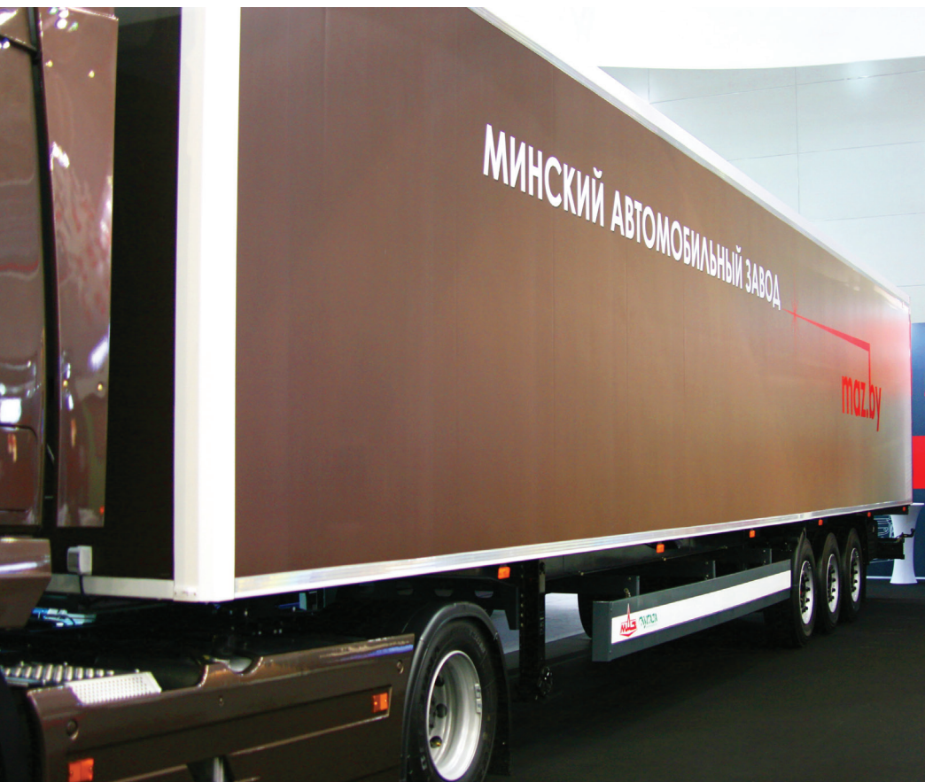
МАЗ-Купава МАЗ-930011 предназначен для международных и междугородных перевозок грузов, требующих сохранности при определенной температуре внутри кузова
