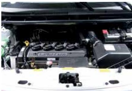
**Lifan X50 оснащается бензиновым двигателем объемом 1,5 л, мощностью 103 л.с., который настроен на потребление бензина АИ-92**
