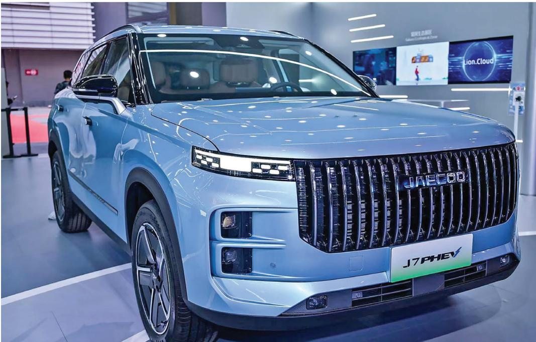
своем классе тепловой КПД – 44,5%. В паре с трансмиссией 1DHT150 гибридный кроссовер выдает суммарную мощность в 255 кВт, а суммарный крутящий момент составляет 525 Н·м.
